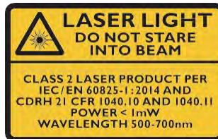
Foto 1 Etiqueta de seguridad láser Clase 2
