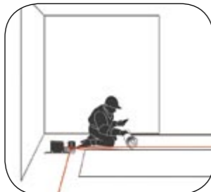
Replanteo de paredes, enlosados y alfombras con el LG2
