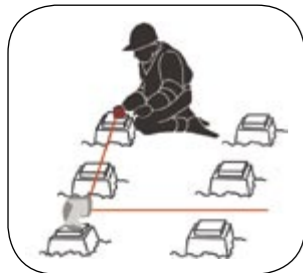
Escuadras y niveles de cimentaciones con el LP40
