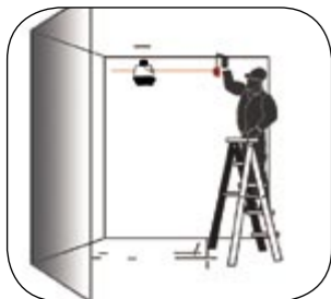
Instalación de techos con el 1422
