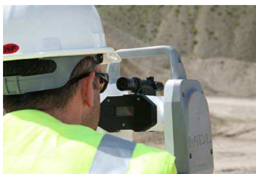
Figura 14: Operación manual del instrumento Quarryman® Pro LR
