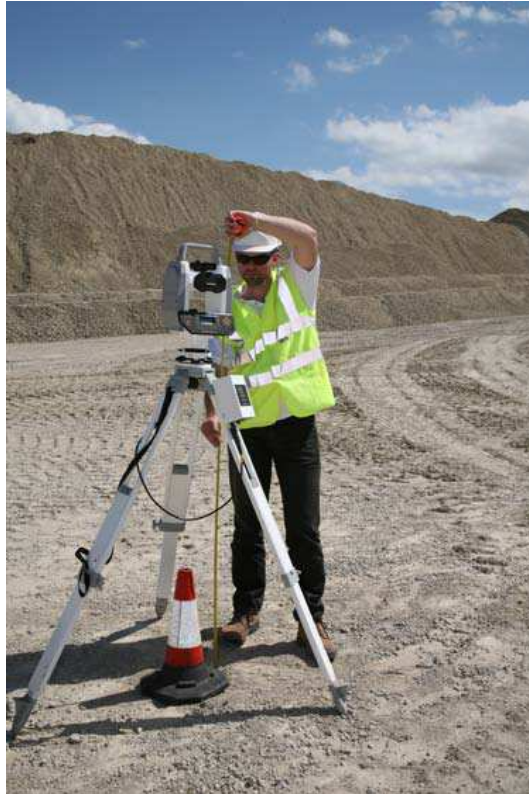
Figura 11: Revise la altura del instrumento
