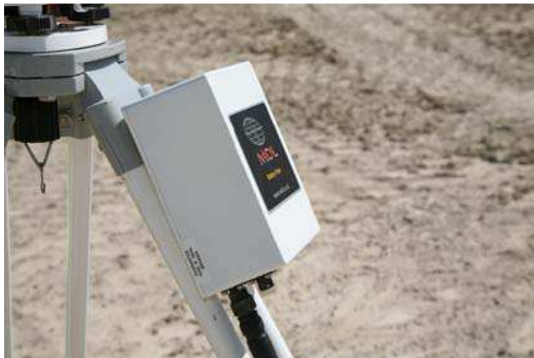
Figura 12: ubicación de la batería sobre el trípode
