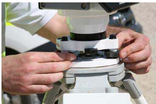
Figura 13: ajuste el tribrach para nivelar el instrumento
